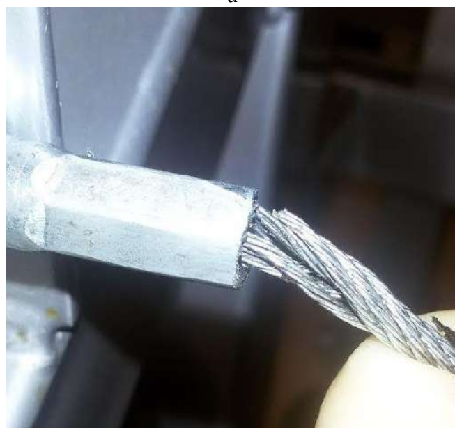
Рис. 5. А — состояние завольцовки силовой пломбы; б — обрыв двух и более нитей каната силовой пломбы
