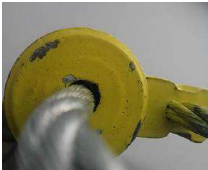
Рис. 4. Следы несанкционированного воздействия в области выходного и входного отверстий: а — от манипуляций щупами; б — от ударного действия
