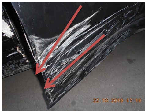
Рис. 1. Пересекающиеся массивы динамических следов на правой передней двери автомобиля Пежо 4007
