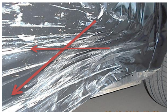
Рис. 1. Пересекающиеся массивы динамических следов на правой передней двери автомобиля Пежо 4007
