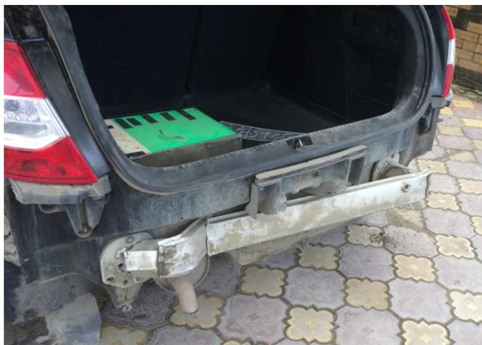
Рис. 2. Повреждение усилителя заднего бампера на автомобиле Ситроен «С4»
