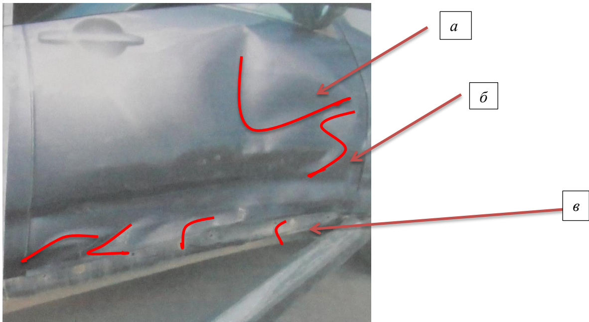
Рис. 2. Повреждения правой передней двери
