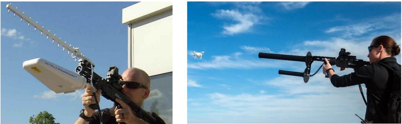
*Рис. 3. Системы направленного радиоподавления систем управления БПЛА*
