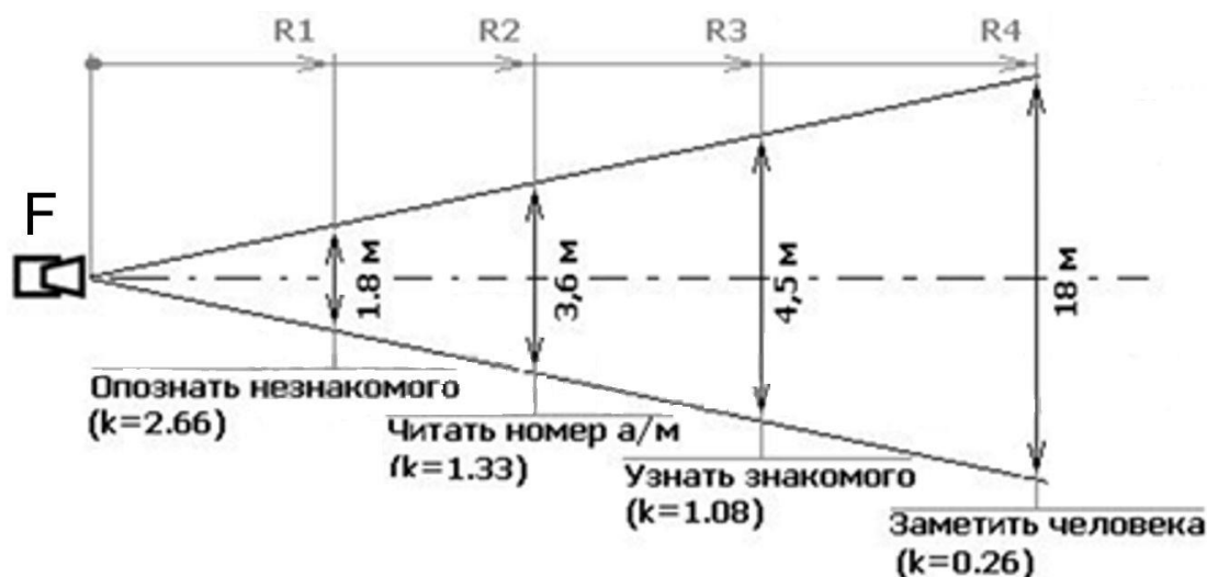
Рис. 3. Взаимозависимость детализации изображений видеокамеры от фокусного расстояния и дистанции
